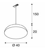
Consommation 40 W Voltage 230 V Couleur luminaire Noir Matériaux Aluminium Longueur 400 mm Largeur 400 mm Hauteur 200 mm E27, Non incluse Source lumineuse
