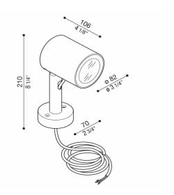
3000 K Couleur Lumière Lumen 1560 lm Consommation 20 W Voltage 220 à 240 V Angle illumination 40° Couleur luminaire Vert Matériaux Aluminium 106 mm Longueur Largeur 82 mm Hauteur 210 mm Source lumineuse LED, incluse 66 Dimmable Dimmable CRI 80 50000 H Durée de vie Garantie 5 ans
